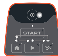
Εγκατάσταση υλικολογισμικού σε εξέλιξη
