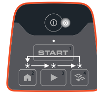
Laiteohjelman asennus on käynnissä
