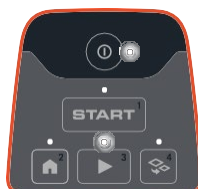
設定された スケジュールで稼働中
